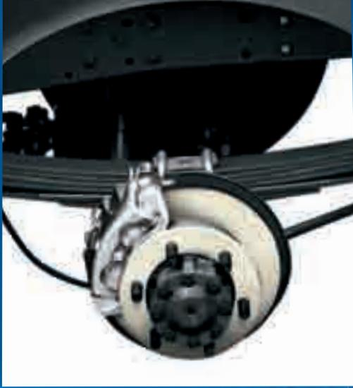
Задняя подвеска с усиленными полуэллиптическими рессорами
